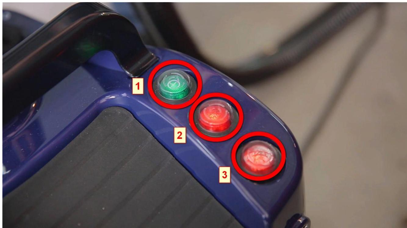
5. Проверить работоспособность функции всасывания путем нажатия белой кнопки на ручке управления. Кнопка подачи моющего средства (красная кнопка с обозначениями «I» и «0») должна быть в положении «0», как указано на рисунке ниже). Мощность всасывания регулируется удержанием белой кнопки на несколько секунд. Вы услышите как двигатель начнет работать с разной нагрузкой.
